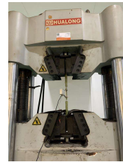
รูปที่ 3.4 การทดสอบรับแรงดึงโดยเครื่องทดสอบอเนกประสงค์
