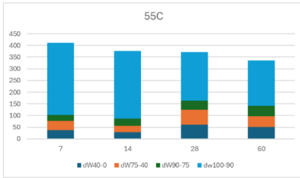
รูปที่10 กราฟแสดง Pore size classification ของ55C
