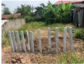
รูปที่ 3.3 การฝังตัวอย่างเสาคอนกรีตในสภาพแวดล้อมการใช้งานจริง
