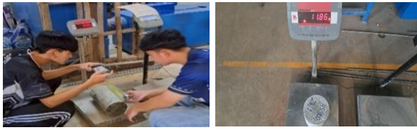
รูปที่ 12 การวัดน้ำหนัก ความกว้างและความยาว
