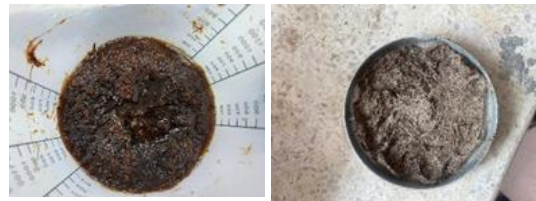
รูปที่ 4 ผักตบชวาที่ผ่านการปรับปรุงคุณภาพก่อนอบและหลังอบ
