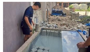
ที่ 11 การนำไปบ่มในน้ำปูนขาว
