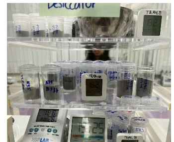
รูปที่6 ตัวอย่างที่ถูกการหยุดปฏิกิริยาปอซโซลาน (Pozzolanic reaction)
