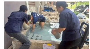
ที่ 11 การนำไปบ่มในน้ำปูนขาว
