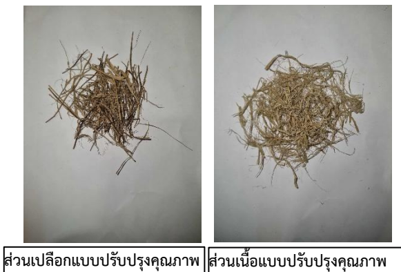
รูปที่ 4 การเตรียมเส้นใยผักตบชวาแบบปรับปรุง คุณภาพ
