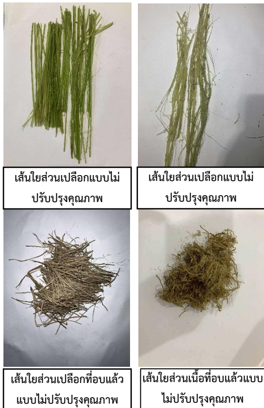
รูปที่ 3 การเตรียมเส้นใยผักตบชวาแบบไม่ปรับปรุง คุณภาพ
