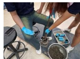
รูปที่ 6 การบดอัดตัวอย่างใส่โมลต์
