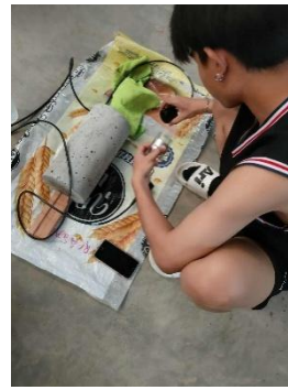
รูปที่ 9 แสดงการทดสอบตัวอย่างคอนกรีตแบบไม่ทำลาย
