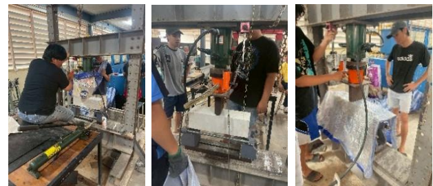
รูปที่ 10 วิธีการทดสอบกำลังดัด
