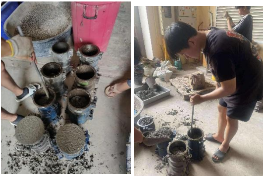
รูปที่ 7 แสดงขั้นตอนการนำคอนกรีตเข้าแบบ
