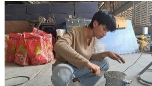
รูปที่ 9 การปรับผิวด้านตัวอย่างคอนกรีต
