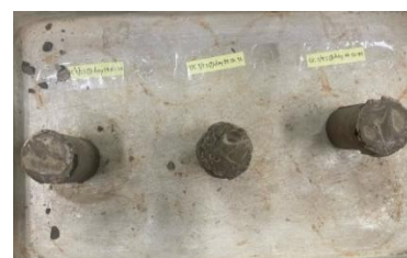
รูปที่ 7 การทดสอบกำลังรับแรงอัดแกนเดียว
