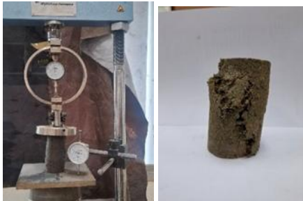
รูปที่ 7 การติดตั้งตัวอย่างกับเครื่อง และหลังการฉีกตัว
