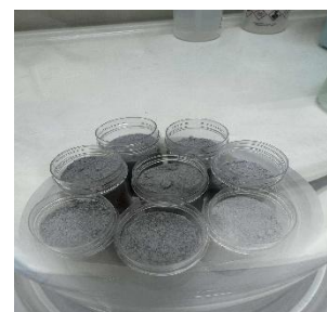
รูปที่6 ตัวอย่างที่ถูกการหยุดปฏิกิริยาปอซโซลาน (Pozzolanic reaction)
