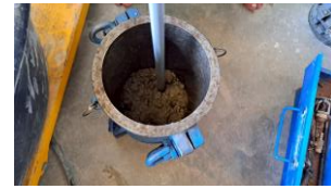
รูปที่ 8 การใช้แท่งเหล็กกระทุ้ง
