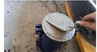
รูปที่ 9 การปรับผิวด้านตัวอย่างคอนกรีต
