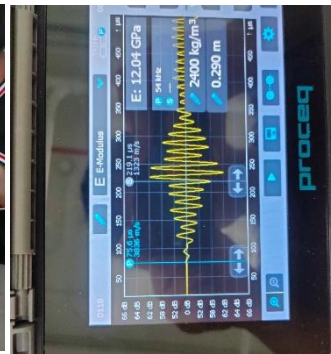
รูปที่ 9 แสดงการทดสอบตัวอย่างคอนกรีตแบบไม่ทำลาย
