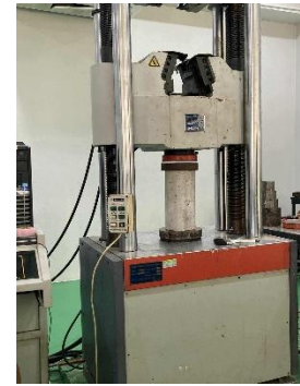
รูปที่ 10 แสดงการทดสอบกำลังอัด
