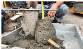
รูปที่ 7 การตรวจสอบค่ายุบตัว
