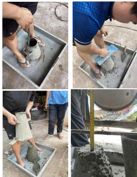
รูปที่ 6 แสดงขั้นตอนการทดสอบค่ายุบตัวของคอนกรีต
